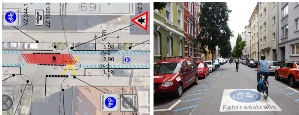
Abbildung 10: Planung Fahrradstraße / eingerichtete Fahrradstraße mit taktilem Sicherheitstrennstreifen zum „Gefahrenbereich Kfz-Türen“ in Offenbach am Main
